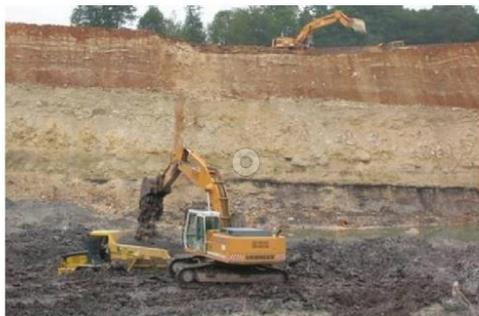
Les argiles réfractaires exploitées (couche gris foncé) sont recouvertes d'une épaisseur de roches calcaires.
